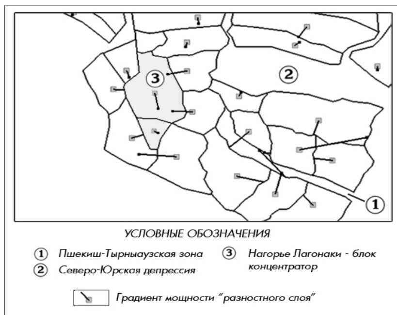
Рис. 3. Градиентное поле тектонических напряжений в блоковой структуре горной части Адыгеи
