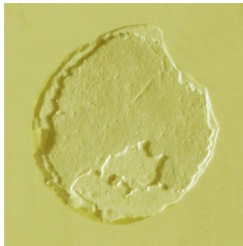
Фото 17. Отрыв VIVALDI STUCKY от DECOR FONDO UCIS. Толщина оторванного слоя 230 мкм. Адгезия 0,9 МПА
