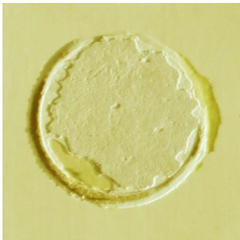
Фото 16. Отрыв VIVALDI STUCKY от DECOR FONDO UCIS. Толщина оторванного слоя 210 мкм. Адгезия 0,1 МПА
