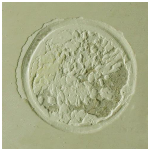
Фото 7. Отрыв EXEDRA SPATOLA от Т03. Адгезия 1,0 МПА
