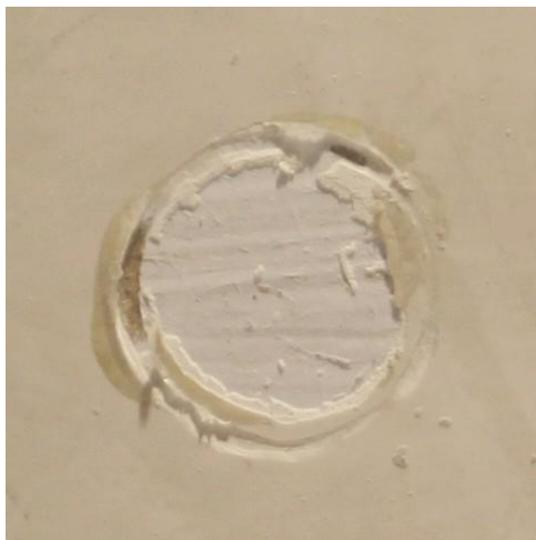
Фото 3. Отрыв EXEDRA SPATOLA от VIVALDI PIANO. Толщина оторванного слоя 220 мкм, адгезия 0,3 МПа
