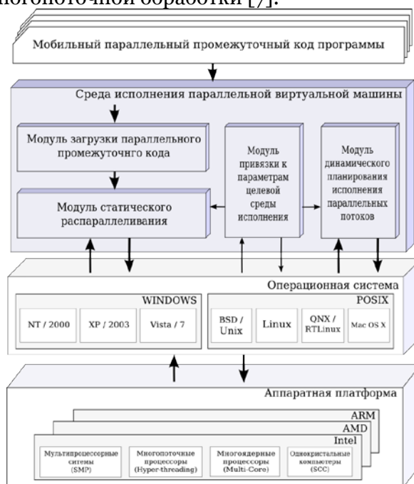
Рис. 2. Программные средства поддержки этапа исполнения мобильного параллельного промежуточного кода
